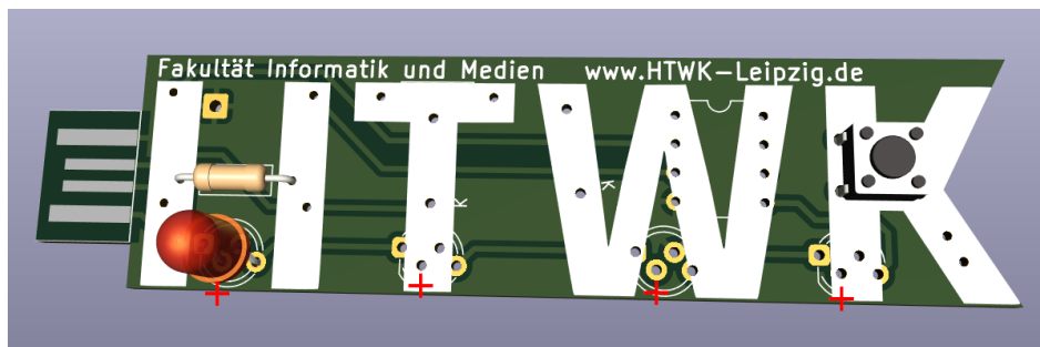
Abbildung 4: Linke WS2811 LED eingelötet. Bitte beachten Sie die Polarität, das längste Bein ("+") kommt in das zweite Loch von Links.
