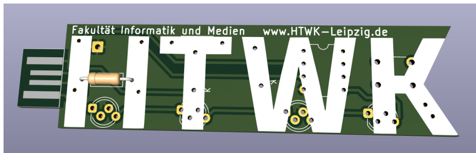
Abbildung 2: 20\,\Omega Widerstand zur Strombegrenzung.
